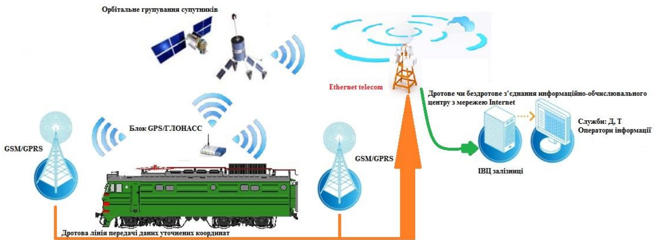
Рисунок 2 – Загальний вид схеми роботи системи глобального позиціонування тягового рухомого складу
